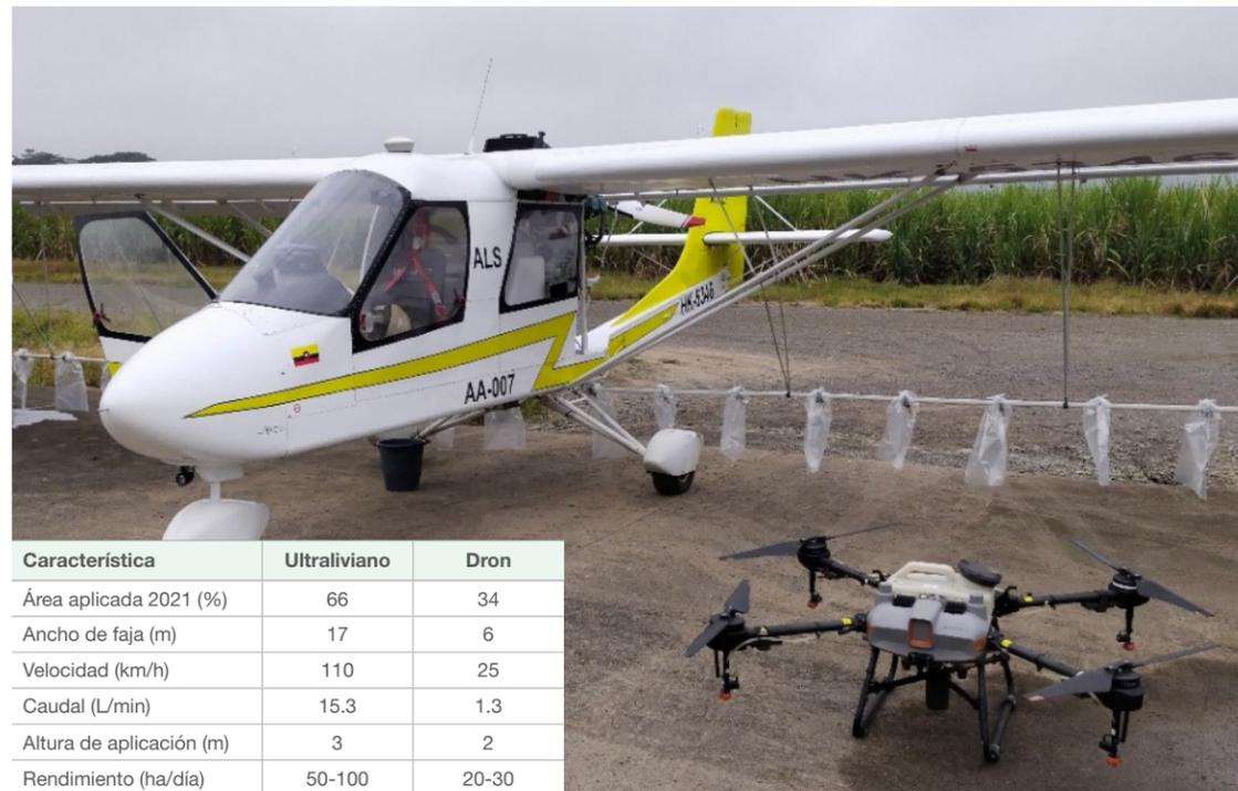
Figura 7. Comparación de características de equipos de aplicación de maduradores en caña de azúcar asumiendo un volumen de descarga de 5 L/ha.
