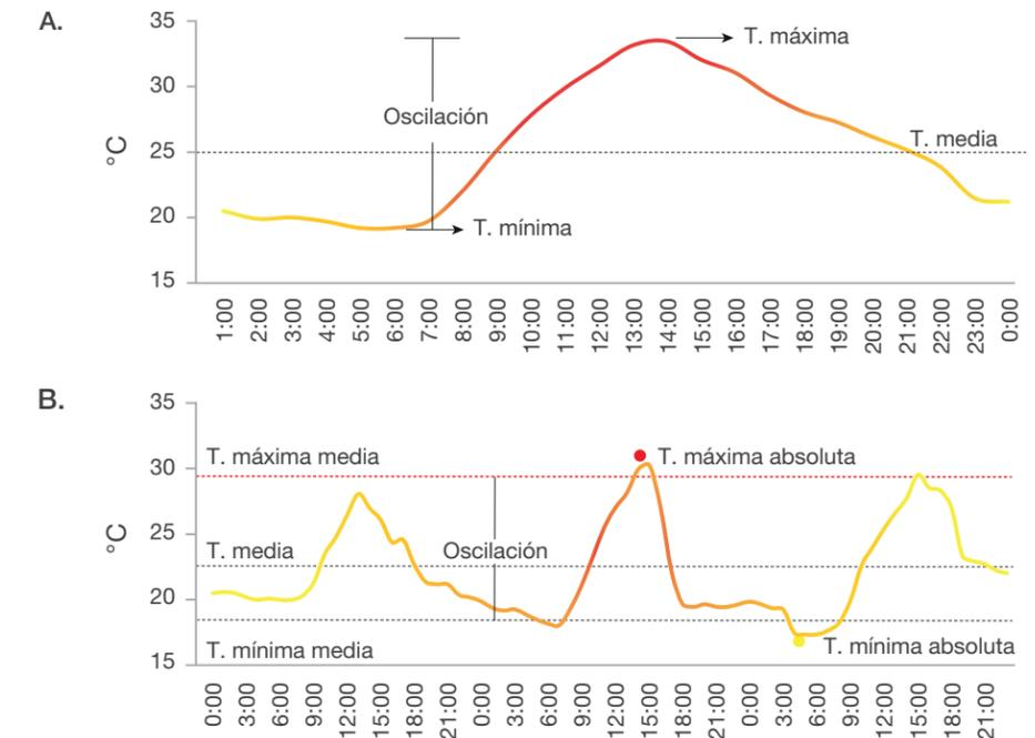
Figura 7. Variables utilizadas para describir el comportamiento de la temperatura del aire en el tiempo: cuatro variables a escala diaria (A); seis variables a otras escalas (B).
