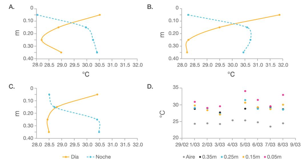
**Figura 13.** Temperatura media del suelo durante el día y la noche en suelos de textura: arcillosa (A); arenosa (B); franca (C); ubicados en la estación Cenicaña. Asimismo, se ilustra: comparación entre la temperatura media diaria del aire (medida en condiciones estándar) y la temperatura media diaria del suelo (D).
