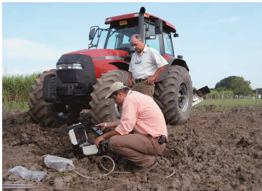
Medición de esfuerzos en el suelo utilizando el Cenisensor.
